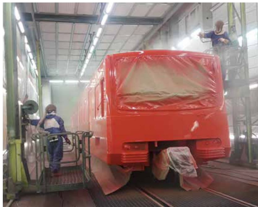
Vaunun 122 pintakäsittely käynnissä VR Fleet Care Oy:n Pieksämäen konepajalla.
