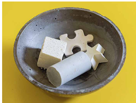
Illikaisen tutkimusryhmä on kehittänyt ekosementtiä muun muassa raudanvalmistuksen sivutuotteena syntyvästä masuunikuonasta tai eristeenä käytettävästä mineraalivillasta.
