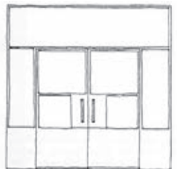
Kuva 2. Ulko-ovet; lasisia ulko-ovia ei likaantumisen vuoksi suositella käytettäväksi muuta kuin oven yläosassa, vähintään 70 mm lattasta ja seinästä. Esimerkki siivouksen kannalta hyvin suunnitellusta ulko-ovesta, jossa on lasia.
