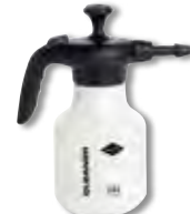
Cleaner 1,51 / 3132 NG Paine 3 bar Paino 410 g Korkeus 29 cm Leveys 24,5 cm Tiivistet Viton. Sopii happamille, nafta- pohjaisille aineille pH 1-9
