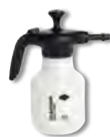
Cleaner 1,51 / 3132 PP Paine 3 bar Paino 410 g Korkeus 29 cm Leveys 24,5 cm Tiivistet Viton Sopii happamille, nafta- pohjaisille aineille pH 1-9
