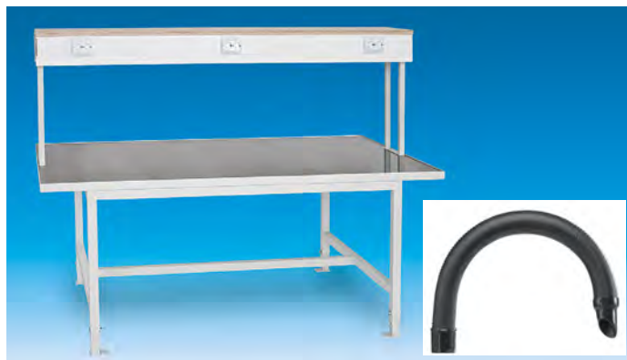
77146 Juotosasemapöytä 1800 x 1000 mm Korkeussäätö h = 700-900 mm. Lattiakiinnitys mahdollisuus. Runko 40x40x2 mm polttomaa- lattua teräsputkea, tasoa kiertää kulmarautaa. Tasona 32 mm lastulevy, jonka päällä teräslevy. Pöydässä taipuisat imukärsät liitetään poistokanavaan. Imukärsien määrä valinnainen.
