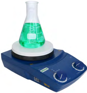
59004C Magneettisekoittaja kuumennuslevyllä Kuumennuslevyn halkaisija 135 mm Lämmitysteho 600 W Portaaton kierrosnopeudensäätö välillä 50–1500 r/m Lämmityslämpötila 0–310 °C Mitat 150 x 250 x 85 mm Paino 1,9 kg
