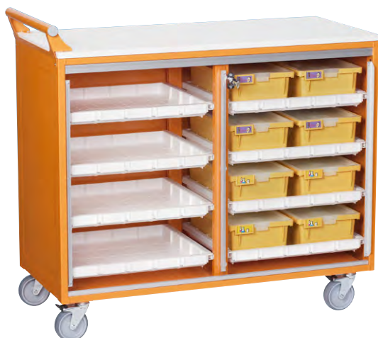
79126 Siirtovaunu 1000x450x850 8 hyllytarjotinta. Runko terästä, rungossa hyllyjen säätörei'itys 25 mm välein. Lukittavat liukuovet, kahva.
