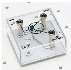
13059 Transistori (etuasteet), suojakot.
