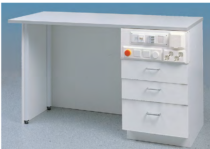
77026 Turvapaneeli opettajan pöytään Kolmivaihepistorasia, magneettiventtiili, hätä-seiskytin, 4 maadoitettua pistorasiaa, himmennin, kytkin. Koko: 500x65x220 mm.
