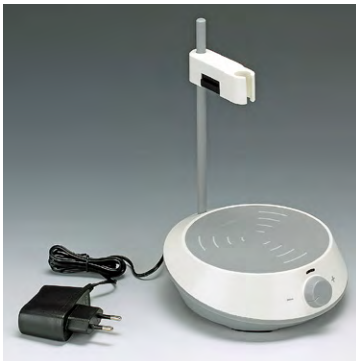
59004C Magneettisekoittaja kuumennuslevyllä Kuumennuslevyn halkaisija 135 mm Lämmitysteho 600 W Portaaton kierrosnopeudensäätö välillä 50–1500 r/m Lämmityslämpötila 0–310 °C Mitat 150 x 250 x 85 mm Paino 1,9 kg
