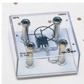
15043 Transistori NPN, suojakotelossa
