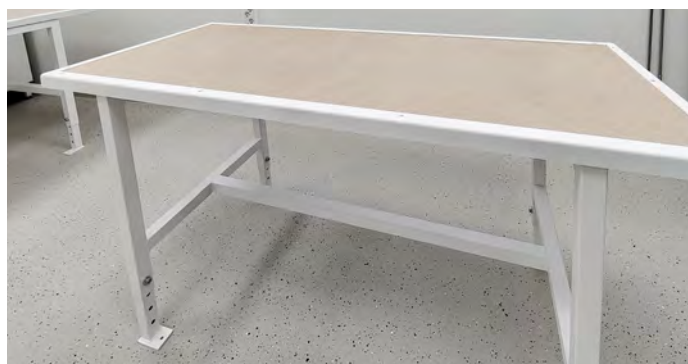
77151 Maalauspöytä 1800x1000x850 mm Runko polttomaalattua terästä, tasoa kiertää kulmarauta. Tason runko 28 mm lastulevy, jonka päällä 6 mm MDF-levy. MDF-levy voidaan kääntää ympäri, jolloin tason käyttöikä pitenee. Muut koot ja tasomateriaalit tilauksesta. Kuvan pöytä erikoismittainen.
