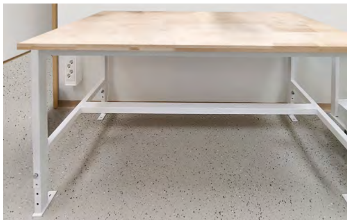
77147B Teknisen työn pöytä 1800 x 1000 mm Korkeussäätö h = 700-900 mm. Lattiakiinnitysmahdollisuus. Runko 40x40x2 mm polttomaalattua teräsputkea. Umpipuutaso.
