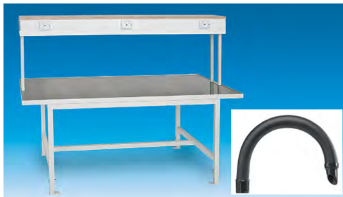
77146 Juotosasemapöytä 1800 x 1000 mm Korkeussäätö h = 700-900 mm. Lattiakiinnitys mahdollisuus. Runko 40x40x2 mm polttomaalattua teräsputkea, tasoa kiertää kulmarauta. Tasona 32 mm lastulevy, jonka päällä teräslevy. Pöydässä taipuisat imukärsät liitetään poistokanavaan. Imukärsien määrä valinnainen.
