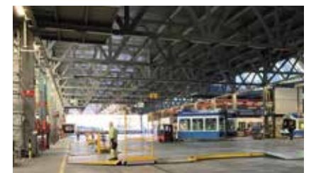
VBZ:n keskuskorjaamo, Altstetten. Kuvassa keskellä on liikkuva alusta, jolla raitiovaunun osat kuljetetaan omiin "lokeroihinsa" korjauksia varten.
