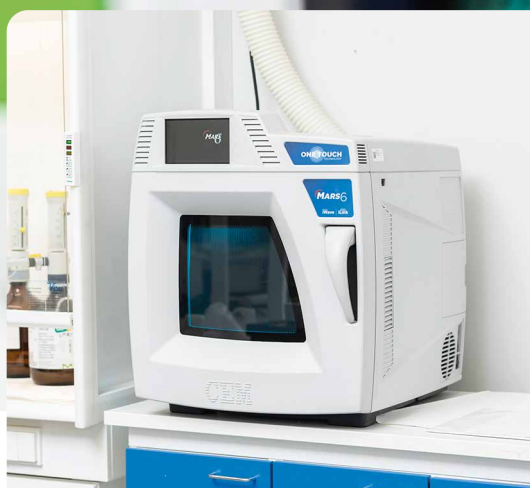
Mikroaaltolahotuksella esikäsitellään analysoitavia näytteitä.
