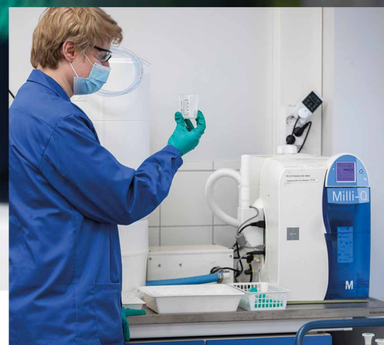
Milli-Q varmistaa, että analyysissä käytettävä vesi on ultrapuhdasta.
