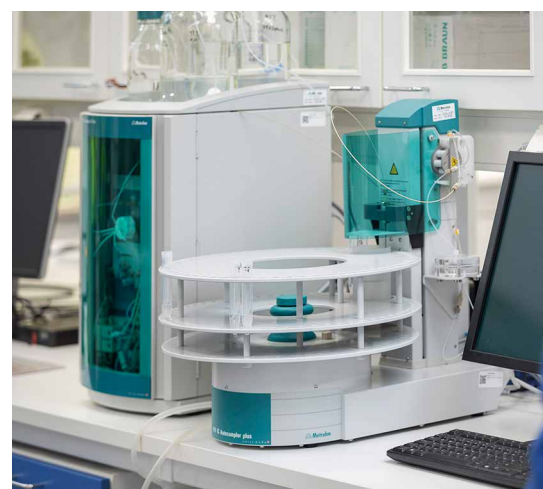
IC:llä analysoidaan kierrätyspolttoaineista muun muassa klooria ja rikkiä.
