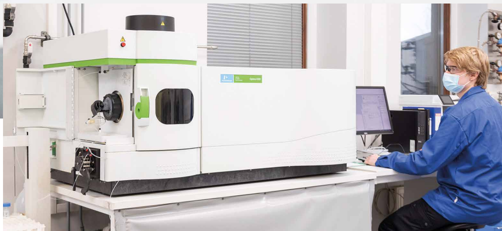
ICP-OES on labran työhevonen. Päivittäisessä käytössä oleva analysaattori määrittää metallipitoisuuksia. Tuloksia voidaan hyödyntää esimerkiksi jalometallimateriaalien hinnoittelussa.
