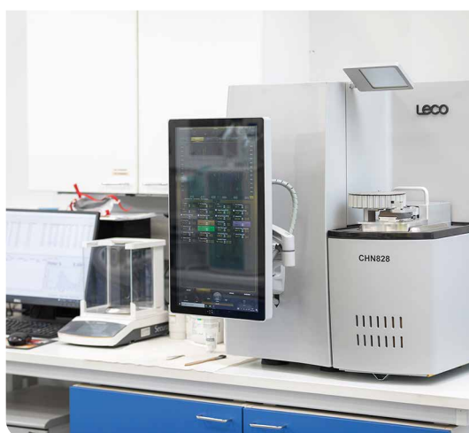
Laboratorion tuorein hankinta on Leco-CHN 828 , jolla analysoidaan kierrätyspolttoaineista hiiltä, vetyä ja typpeä
