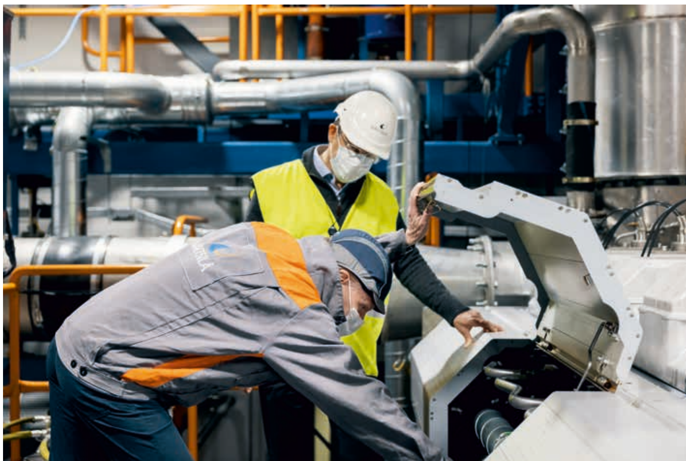
Wärtsilän moottorilaboriotiimi suorittaa Vaasassa laaja-alaisia testejä optimaalisten parametrien määrittämiseksi vety- ja ammoniakkipolttoaineilla toimiville moottoreille. © Wärtsilä Corporation
