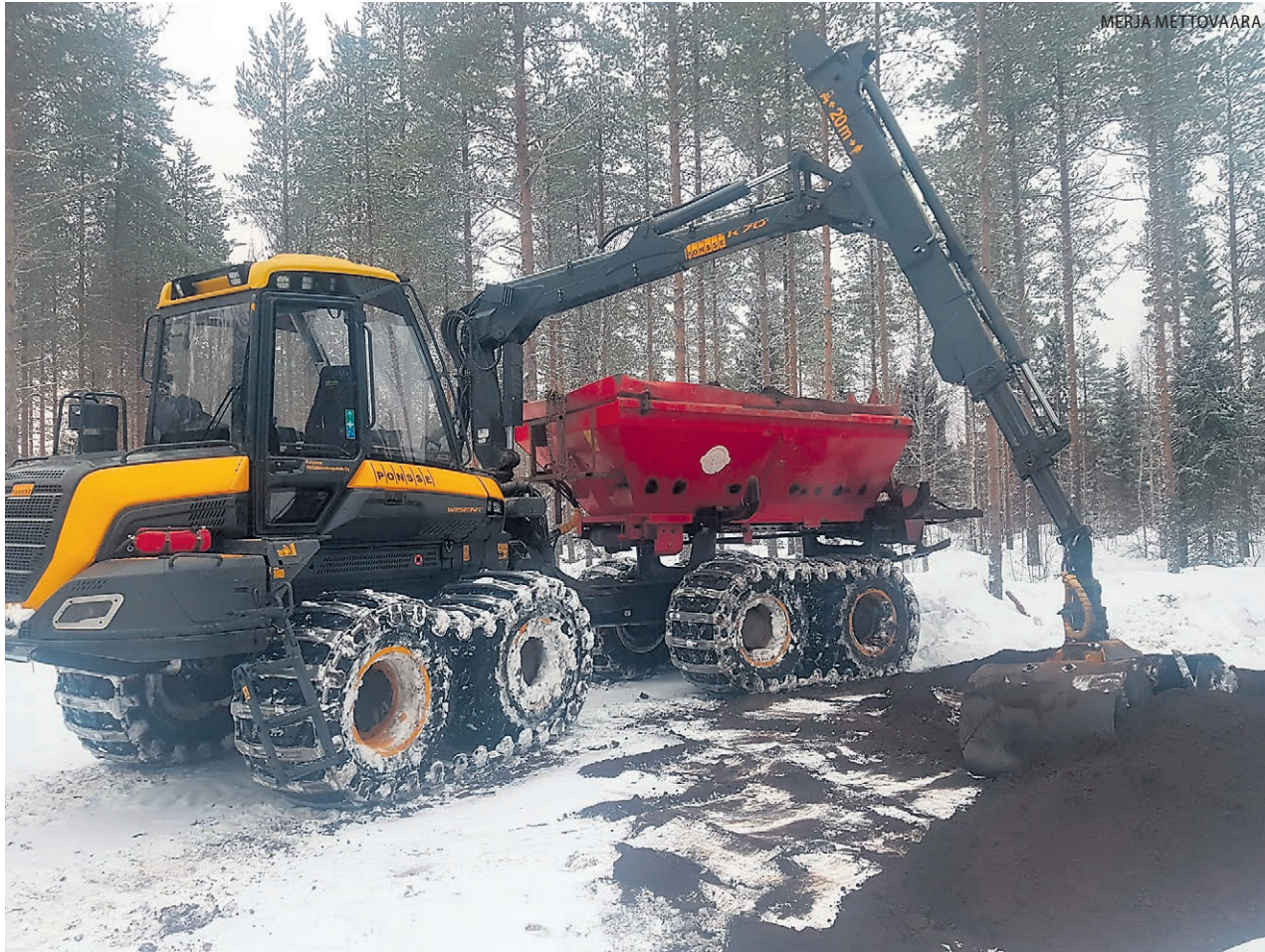
Tuhkaa levitetään suometsiin maalevityksenä aliurakoitsija Sampo Moilasan Ponssellalla. Pääosin levitys tapahtuu kuitenkin helikopterityönä ilmasta.
