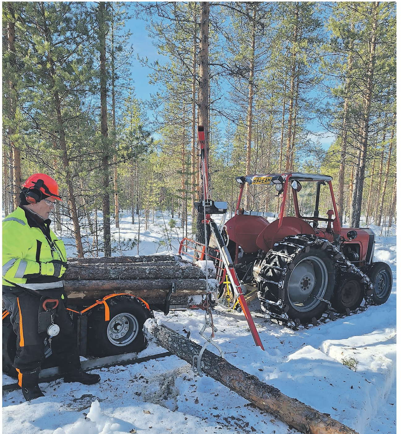
Sähkötoimisella vinssillä tukit siirtyvät kuormaan kevyesti
