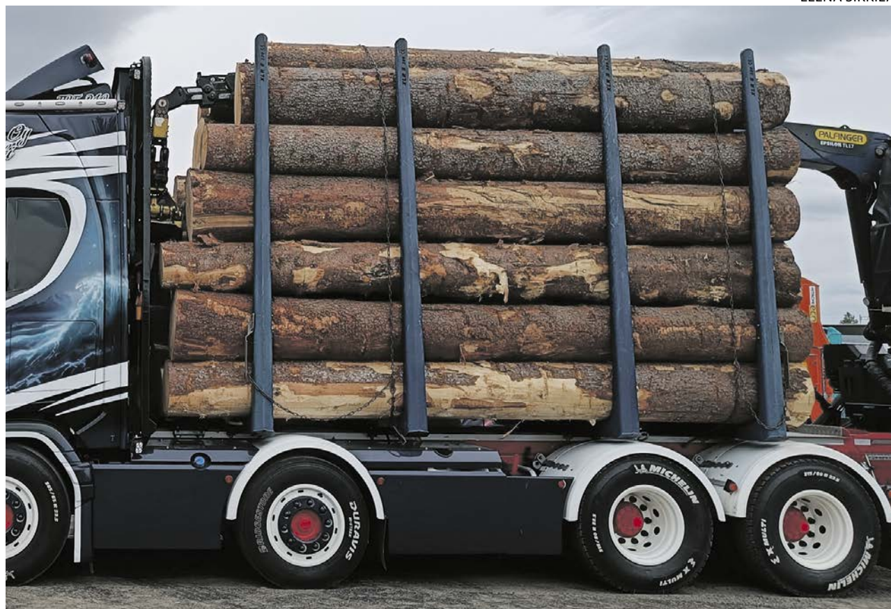
Ylijäreäksi tukiksi lasketaan tyypillisesti halkaisijaltaan vähintään 55 cm oleva tyvitukki.
