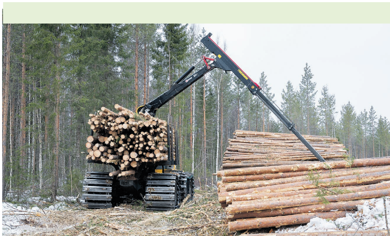
Ajokoneen leveät telat mahdollistavat puunkorjuun pehmeämmässä maastossa.
