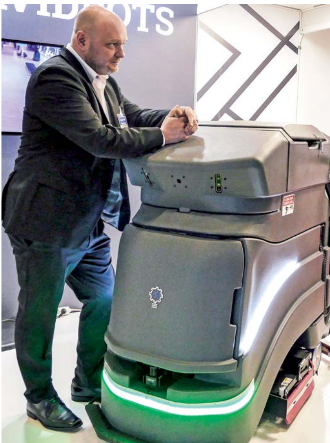
Sami Mustonen Rotator Oy:stä esitteli Neo-siivousrobottia. Avidbotsin valmistamassa Neossa on paljon erilaista nykYTEKNOLOGIAA, kuten Wi-Fi, 4G, laser- ja 3D-kamerat. Yhdellä latauksella virtaa riittää 4-6 tunnin toimintaan.
