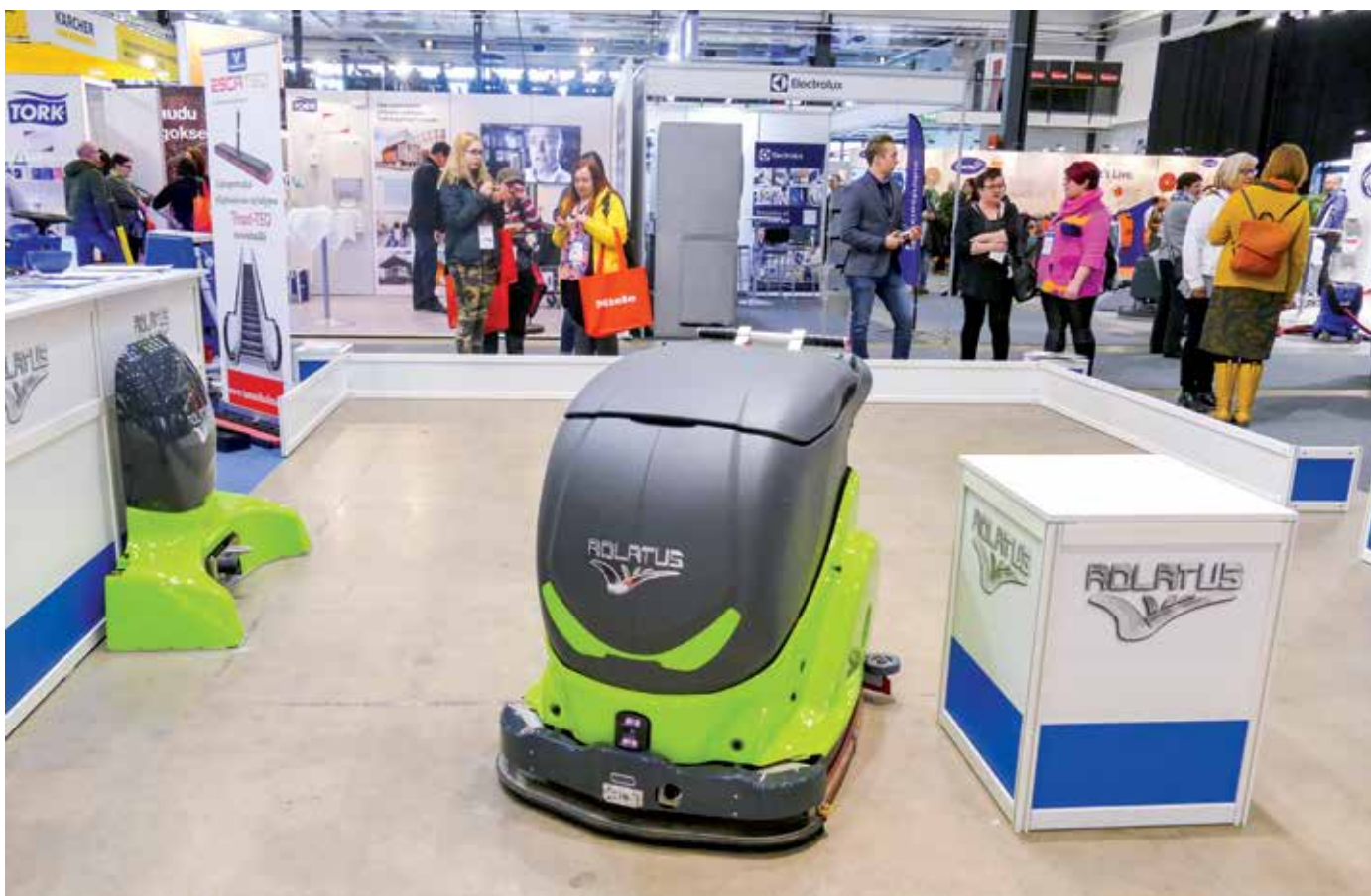
Tammiholma Oy esitteli messuilla uuden automaattisen siivousrobotin Adlatus CR700:n. Robotti kulki osastolla itsekseen aidatulla alueella. Robotin lika-vesisäiliön täyttyessä, puhdasvesisäiliön tyhjentessä tai akun varaustason vähentyessä alhaiseksi robotti menee itsenäisesti telakointiasemaan.
