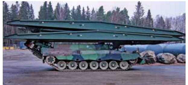
Siltapanssarivaunu Leopard 2L kuljetuskonfiguraatiossa kahden 14 m sillan kanssa
