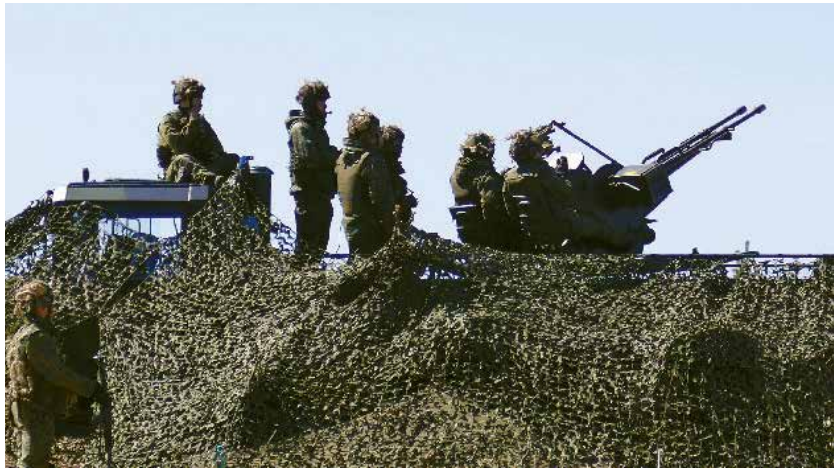
23 ITK 95 on Suomessa modernisoitu versio 23 ITK 61:stä. Mekaaninen ammunnanhallintajärjestelmä on korvattu elektronisella. Puolustusvoimat
